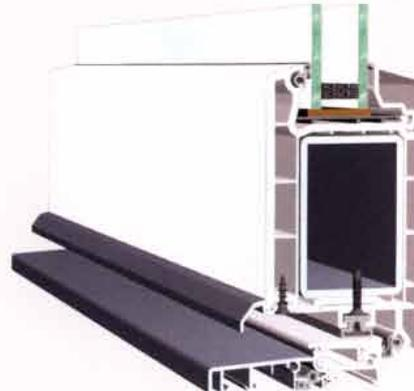
Die Bodenschwellen aller dtH Haustüren sind nach DIN 18025 rollstuhlgerecht und einfach zu überfahren. Bei Hebe-Schiebetüren sind flache Bodenschwellen aus Aluminium mit thermischer Trennung Lieferstandard. Sie können auf Wunsch auch barrierefrei nach DIN 18025 ausgeführt werden.
