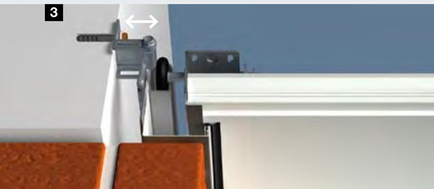
**3** Montage bei nichttragenden Fassaden (Klinker oder Wärmedämmung) mit min. 90 mm / max. 125 mm Seitenanschlag
