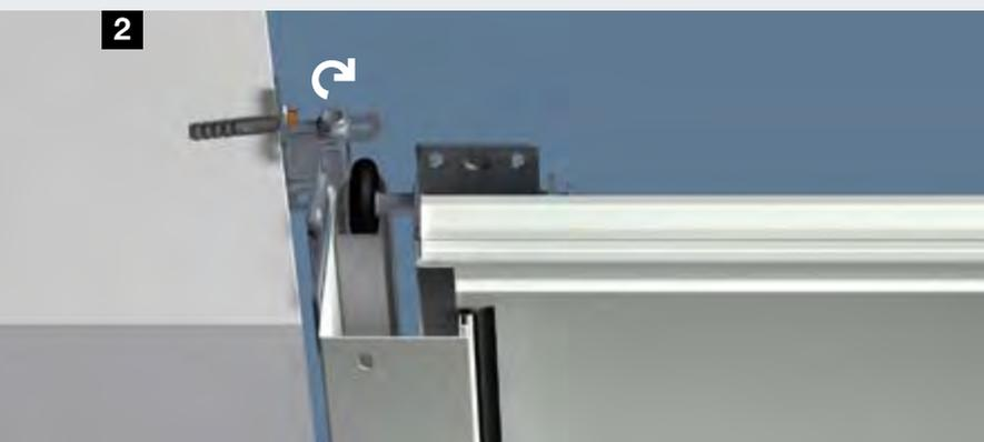
**2** Montage bei schräger und unebener Seitenwand
