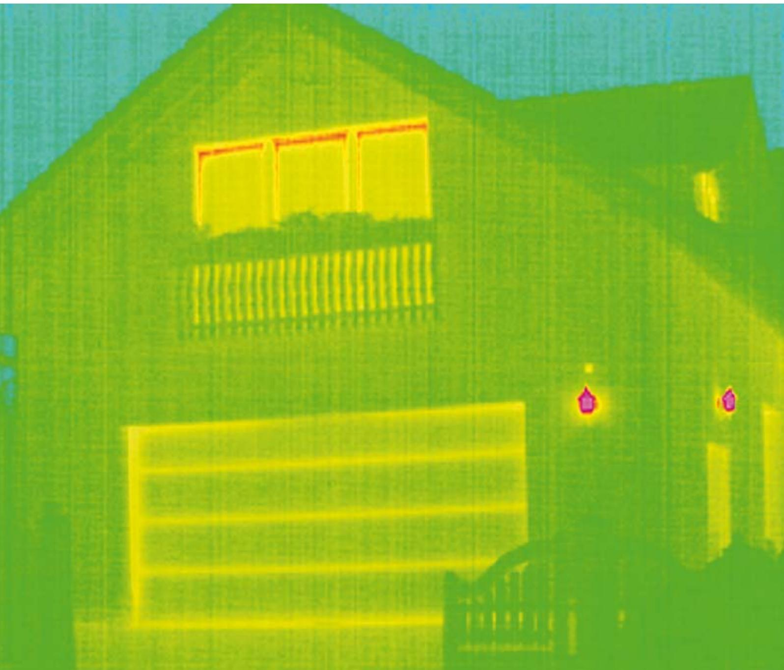
Wenn Garage und Haus direkt miteinander verbunden sind, empfiehlt sich ein gut gedämmtes Garagentor. Der neue ThermoFrame Zargenanschluss verbessert die ohnehin guten Dämmeigenschaften der doppelwandigen Hörmann Garagen-Sectionaltore.
